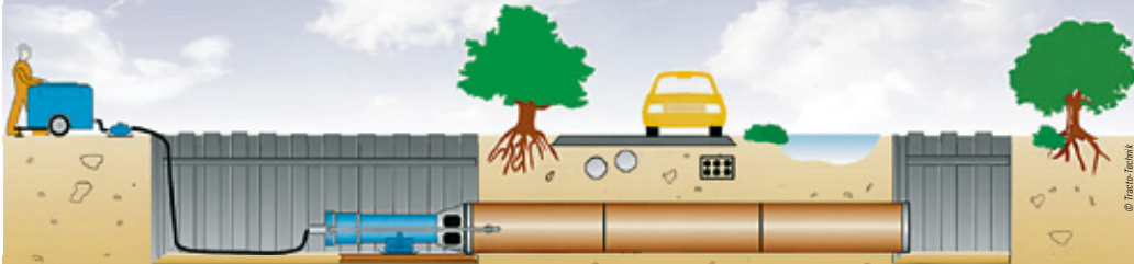
Beim dynamischen Rammverfahren sind Umleitungen oder auch halbseitige Straßensperren unnötig.
